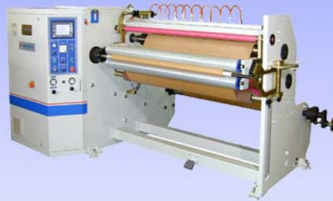
HY-SPL 單軸中心表面複捲機 捲取直徑 300mm 捲取管心:1"-3"
