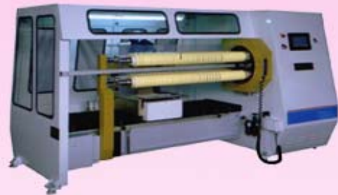
HY-FQ 單刀四軸交換自動切卷機 切割直徑 180mm 切割軸管心:3"
