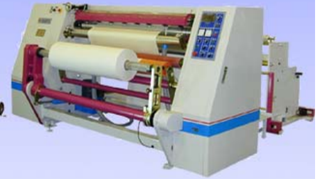
HY-SDT 單軸中心表面複捲機 捲取直徑:600mm 捲取管心:3"
