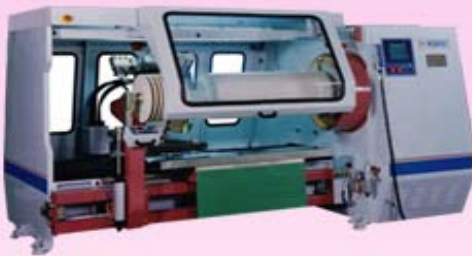
HY-FJ 單軸自動切卷機 切割直徑 500mm 切割軸管心:3"
