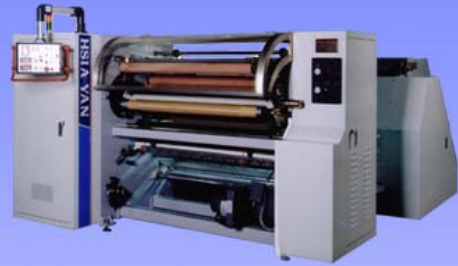
HY-GA 中心表面雙軸交換全自動複捲機 捲取直徑 180mm 捲取管心:3"
