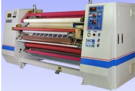
HY-LT 表面無軸複捲機 捲取直徑 200mm 捲取管心:1"-3"
