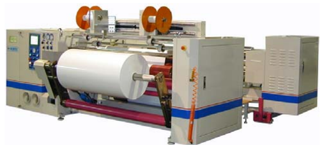
HY-SD 單軸中心與表面分條機 適用於各種商標紙及紙張之分條 最大入料直徑:1000mm 最小分條:依收捲直徑而定 本機可選擇捲取直徑:600mm & 1000mm
