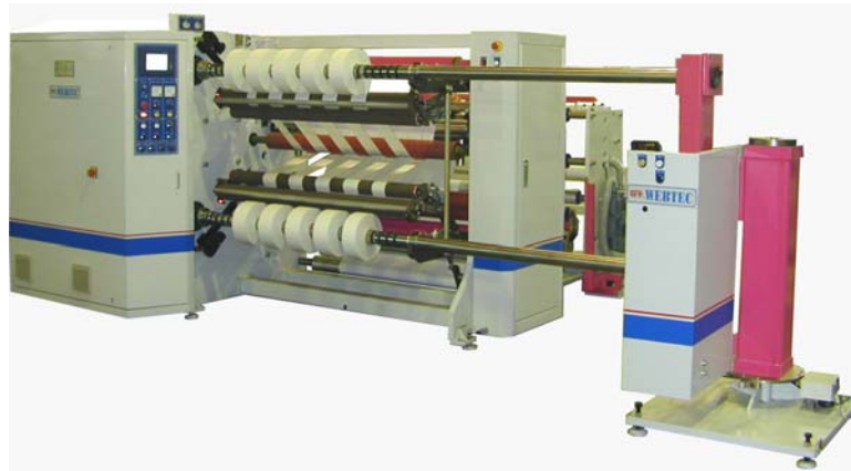
HY-TA 雙軸中心收捲分條機 適用於各種商標紙，膠片及紙張等分條 最大入料直徑:1000mm 最小分條:50mm. 本機可選擇收捲直徑: 600mm & 800mm
